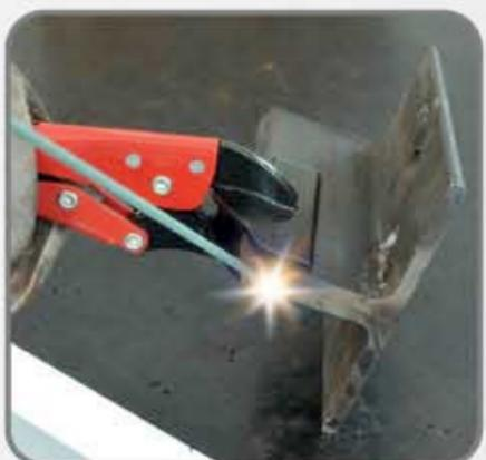
**4128 Pinza para hojalatero** Punta diseñada para sujetar firmemente materiales delgados como láminas metálicas.
