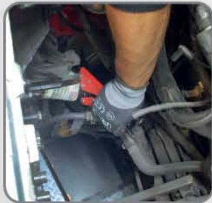
**4122 Pinzas de presión para filtro** desmonta filtros de aceite de automóviles.
