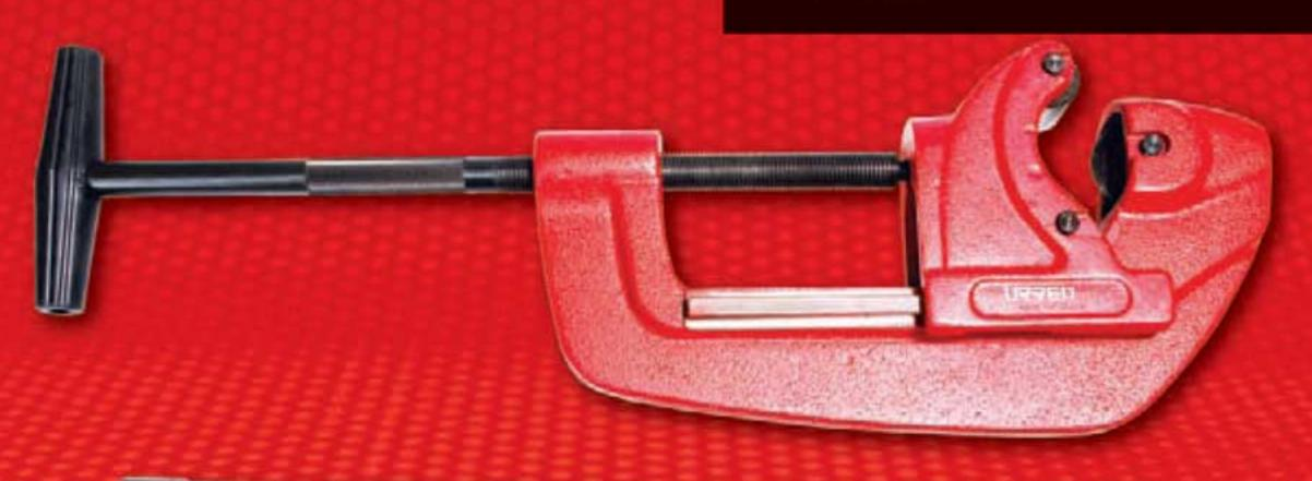
Capacidad de corte de 2 " a 4" (51 a 102 mm) Sistema de muelle por arandelas Lo cual ofrece un mejor corte y mayor duración a las cuchillas.
