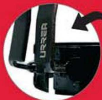
• La pinza puede ser usada en posición paralela o perpendicular al block de cilindros.
