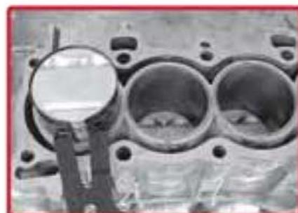
• La banda trabaja posicionándose alrededor del pistón, cubriendo los anillos, las pinzas enganchan la banda y oprimen el anillo contra el pistón facilitando la instalación en la cabeza del motor.
