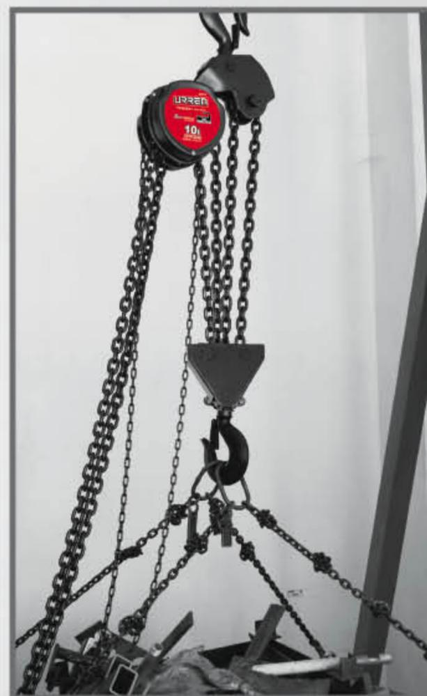
Gancho giratorio de acero forjado con traba de seguridad.
