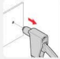
3. Inserte la cabeza del remache en el orificio del material a remachar.
