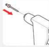
4. Accione el brazo palanca hasta zafar el vástago del remache.
