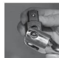
2.- Introduzca el cabezal dentro de la horquilla del mango.
