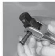
3.- Pase el tornillo por el barreno del cabezal y horquilla del mango.
