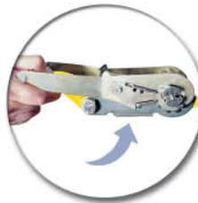
Dispositivo manual de tensión por medio de matraca.
