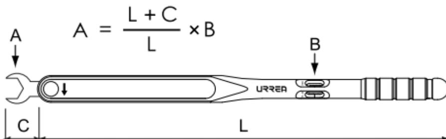
Un número de variables incluyendo la longitud el adaptador o de la extensión, la longitud del torquímetro y las variaciones en la posición de la mano, afectarán la precisión del cálculo anterior.
