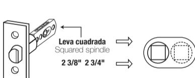
Este picaporte es ajustable. Para ajustarlo a la posición de 2 3/4" (70 mm), jale la leva cuadrada hasta que llegue a la posición 2 3/4" (70 mm).
