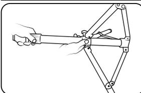
1. Tome la base plegable tipo trípode (2) y empuje el conector central hasta extender las patas.
